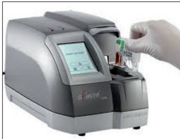
Fig. 2. Introducció del kit amb la sang capil·lar en l'autoanalitzador Afinion®, que la processa automàticament sense necessitat de manipulació. El resultat s'obté al cap de cinc minuts. Font: observació personal.
