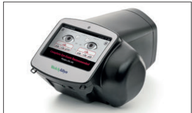
Fig. 6. Autorefractòmetre binocular Spot™ Vision Screener®. Mostra una representació de l'alineació ocular en pantalla durant la prova, i el resultat de la refracció un cop feta, amb la indicació de la necessitat o no de derivar a l'oftalmòleg.
