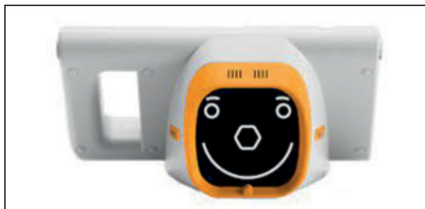
Fig. 7. Dibuix d'una cara a la pantalla de la càmera de l'autorefractòmetre que l'infant veu durant l'exploració. Crida l'atenció perquè hi dirigeixi la mirada. Durant l'exploració, a més, emet un so per captar la seva atenció.
